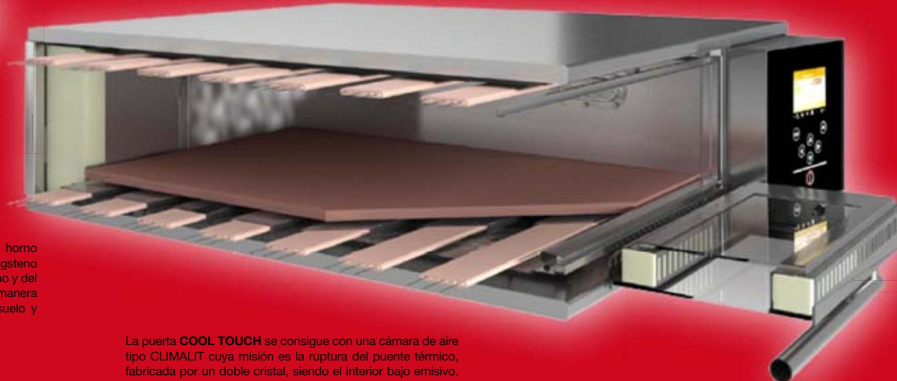
La puerta **COOL TOUCH** se consigue con una cámara de aire tipo CLIMALIT cuya misión es la ruptura del puente térmico, fabricada por un doble cristal, siendo el interior bajo emisivo. Todo el calor generado queda en el interior.
