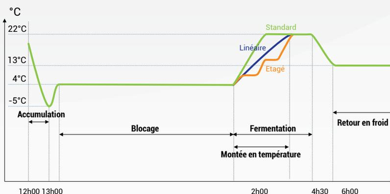
Le retour en froid s'effectue automatiquement en fin de phase de fermentation. Le cycle reprend automatiquement en cas de coupure de courant tout en affichant un message d'avertissement.
